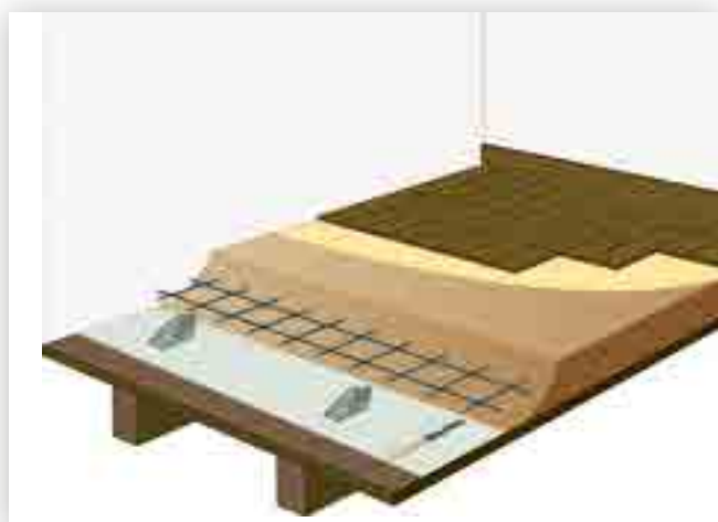
Impermeabilizzazione soletta collaborante in Calcestruzzo CentroStorico
