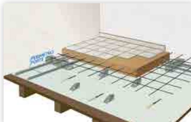
Consolidamento antisismico con cerchiatura perimetrale (Perimetro Forte) e rinforzo statico.
