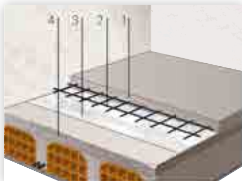
Solai in laterocemento/calcestruzzo.
